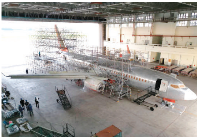
A320與737-800機型之機翼與尾翼可移動式施工平台架
